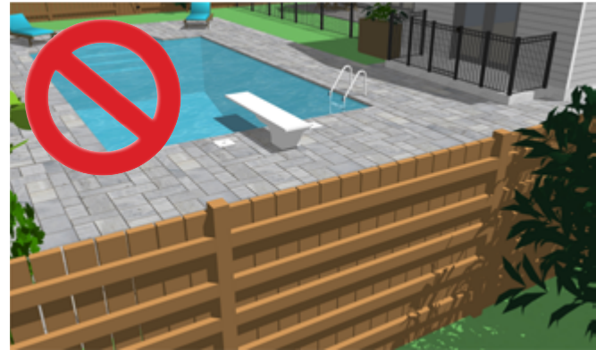
Les travers horizontaux sont trop rapprochés et pourraient permettre à un enfant d'escalader la clôture.
