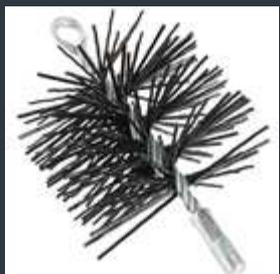
La brosse de ramonage doit être de forme et de grosseur adaptée à la cheminée. Les brosses de polypropylène sont les plus populaires pour les cheminées préfabriquées ou les chemisages, flexibles ou rigides, en acier inoxydable, car elles ne laissent aucun dépôt métallique corrosif sur leur paroi intérieure. Il existe cependant des brosses de métal à brins fins homologuées pour ce type de cheminée ainsi qu'une grande variété d'autres modèles en acier destinés aux cheminées de maçonnerie.
